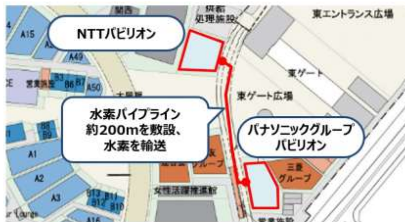
NTTパビリオン-パナソニックグループパビリオン間の水素パイプライン敷設ルート
