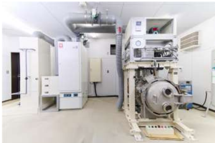
全固体電池向け安全性試験装置 (左：排ガス処理装置、右：圧力密閉容器)
