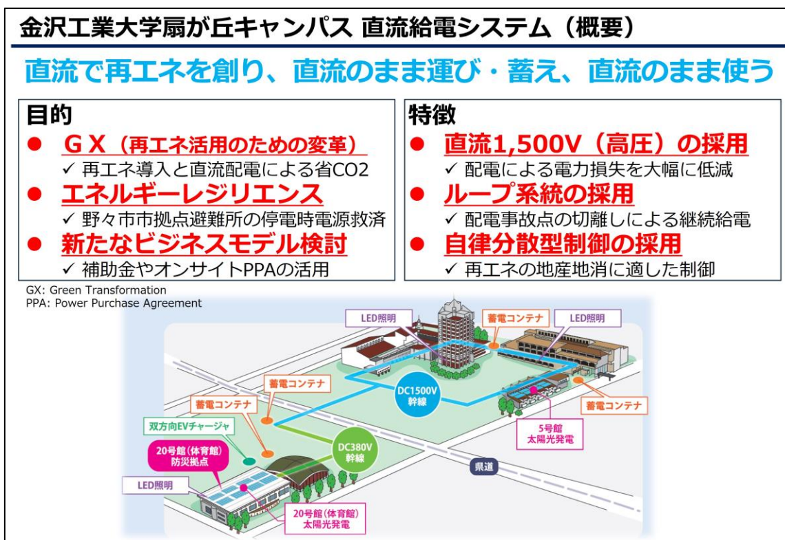
図 1 金沢工業大学扇が丘キャンパスの 直流給電システム
